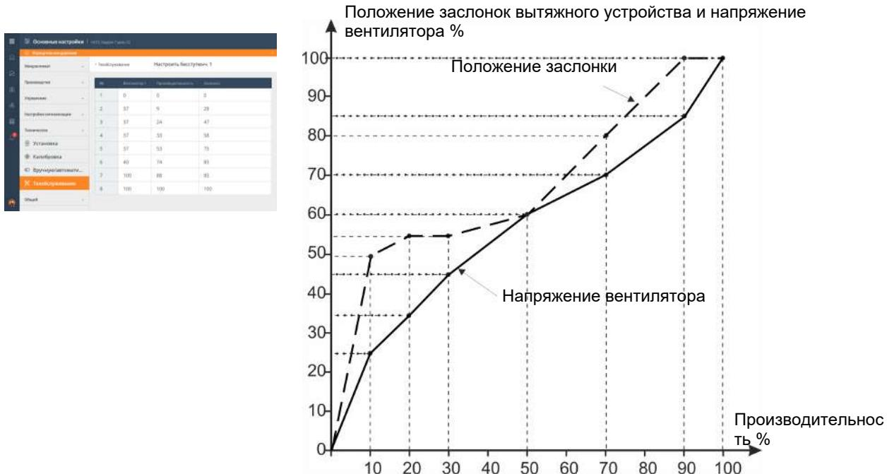
Рисунок 10: Регулировка бесступенчатого устройства
