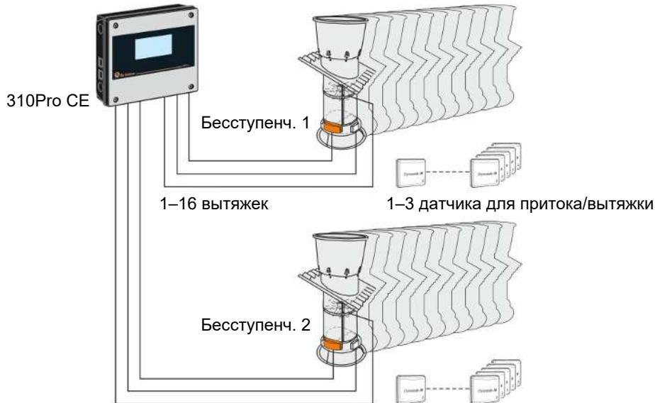
Рисунок 7: Количество датчиков Dynamic Air для центральной вытяжки в блоке вентиляторов
